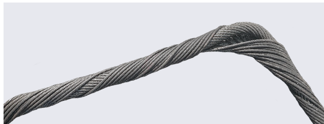
Heraustreten der Stahlseileinlage bei drehungsfreien Seilen
