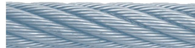
Abb. 37: Zustand bei 20% der Biegewechselform bis Bruch
