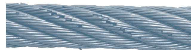
Abb. 40: Zustand bei 80% der Biegewechselform bis Bruch
