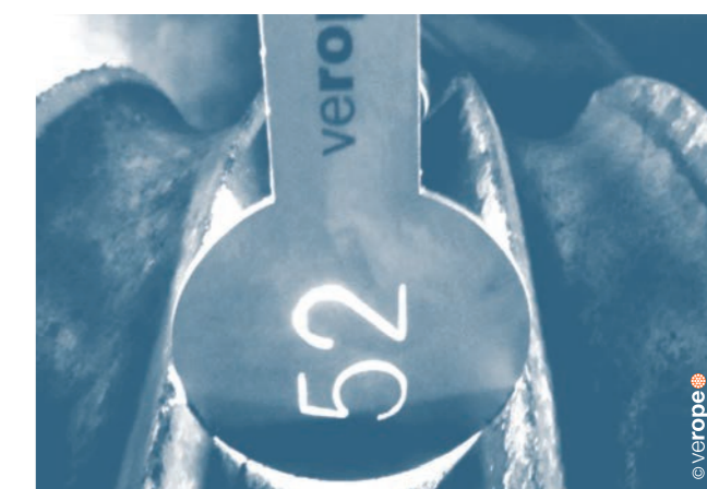
Abb. 74: Rillenlehre (hier in zu enger Seilrille)
