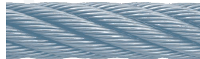
Abb. 36: Zustand bei 0% der Biegewechselform bis Bruch (Neuzustand)
