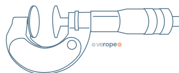
Abb. 11: Bügelmessschraube mit breiten Messflanken
