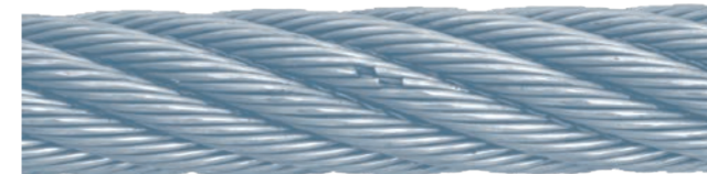
Abb. 38: Zustand bei 40% der Biegewechselform bis Bruch
