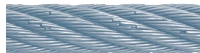
Abb. 39: Zustand bei 60% der Biegewechselform bis Bruch
