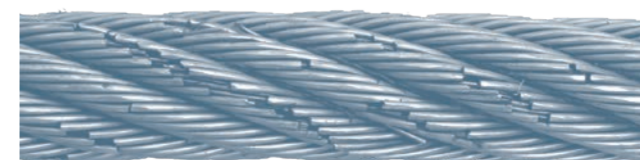
Abb. 41: Zustand bei 100% der Biegewechselform bis Bruch (Zone nahe Seilbruchstelle)
