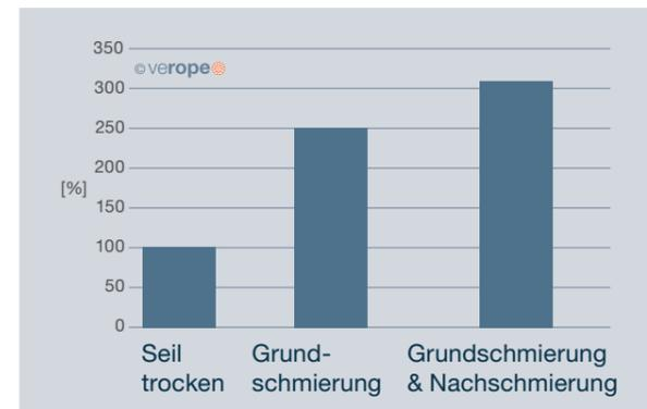
Abb. 22: Einfluss der Nachschmierung auf die Seillebensdauer
