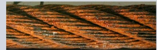
4. Oberfläche stark zerfressen, Drähte spannungslos, Lücken zwischen Drähten. Unverzögliche Ablage.
