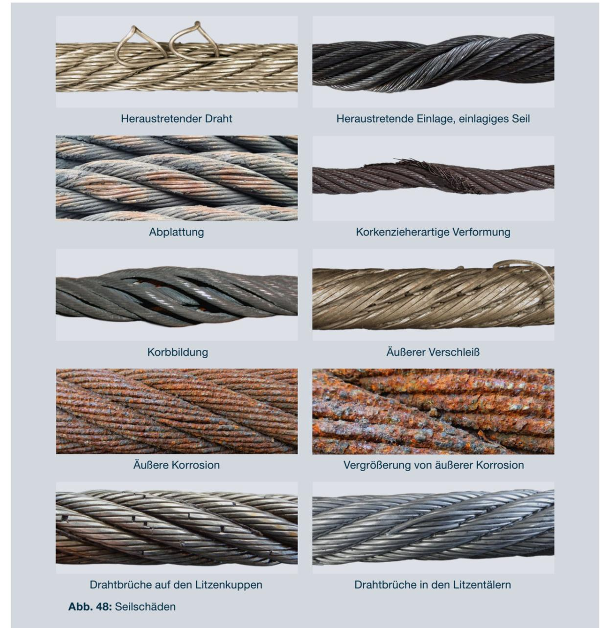
Abb. 48: Seilschäden
