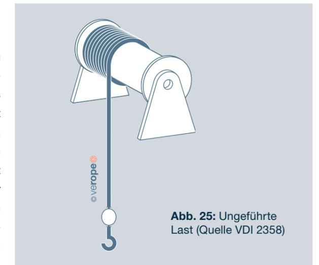
Abb. 25: Ungeführte Last (Quelle VDI 2358)
