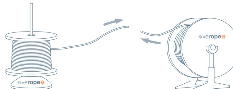
Für Seile, die auf Trommeln aufgespult werden, ist es zusätzlich wichtig, dass die richtige Spulrichtung eingehalten und das Seil mit einer Vorspannung installiert wird. Wird das Seil von oben auf die Trommel aufgespult, muss das Seil ebenfalls von der Haspel oben ablaufen. Eine Kreuzung dieser Richtungen hat
