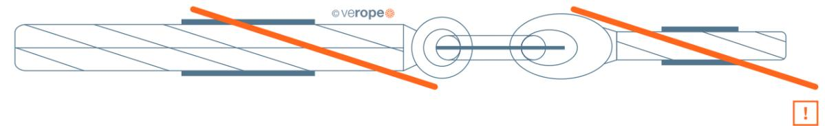
**! NUR SEILE MIT GLEICHER SCHLAGRICHTUNG VERBINDEN !**
