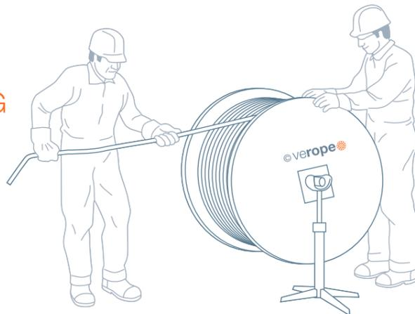
Das Abziehen des neuen Seiles von einer stationären Rolle oder nicht drehenden Haspel führt zu Verdrehungen im Seil und das Seil kann bereits bei der Montage zerstört werden. Bei einigen Kranen kann es ratsam sein, das alte Seil zuerst abzulegen und danach das neue Seil zu installieren. Bei anderen Kranen, besonders bei größeren Kranen, ist es möglicherweise besser, das neue Seil an dem alten Seil zu befestigen und einzuziehen.
