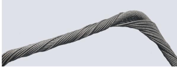
Heraustreten der Stahleileinlage bei drehungsfreien Seilen
