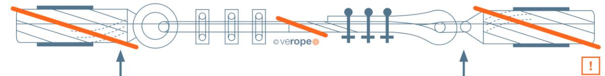
Neuseil mit Kontrollmarkierung für Drehwirkung
