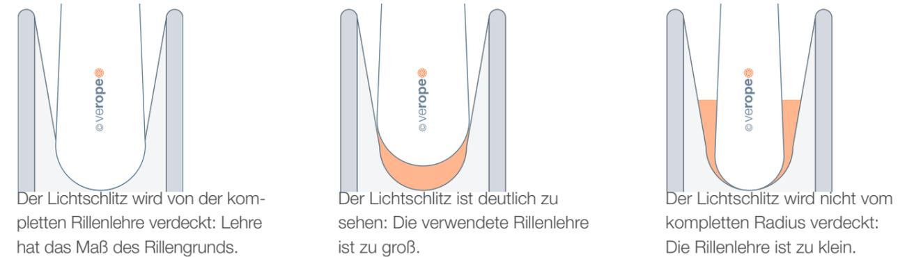
Laut Norm sollte der Rillradius R zwischen 0,525 x d und 0,550 x d liegen, optimal liegt der Rillradius bei 0,5375 x d.
