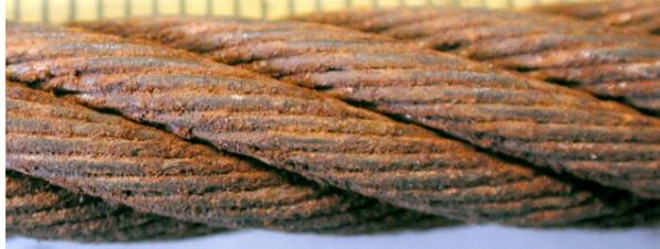
2. Cables ásperos al tacto, oxidación general de la superficie - Clasificación: 20% hacia el descarte
