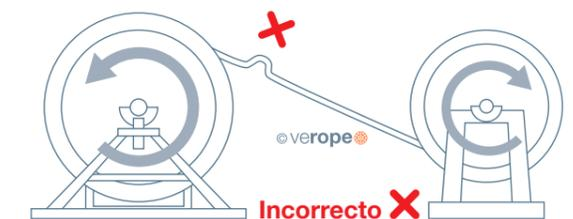
De acuerdo con la norma, se debe aplicar una pretensión equivalente de al menos 2.5% a 5% de la carga mínima de ruptura. A menudo, estos valores no pueden lograrse con los dispositivos disponibles, por lo
