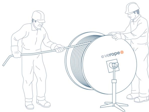
El desenrollamiento de un cable nuevo desde un rollo estacionario o carrete no rotatorio, lleva a torsiones en el cable, y el cable en el momento del montaje podría ya estar dañado.
