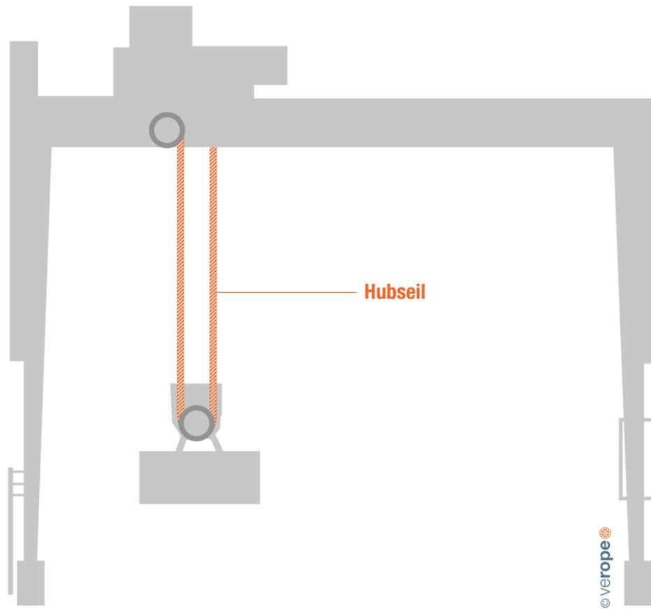
In der Regel werden bei dieser Anwendung die Spezialdrahtseile paarweise, das heißt rechts- und linksgängig, eingesetzt.
