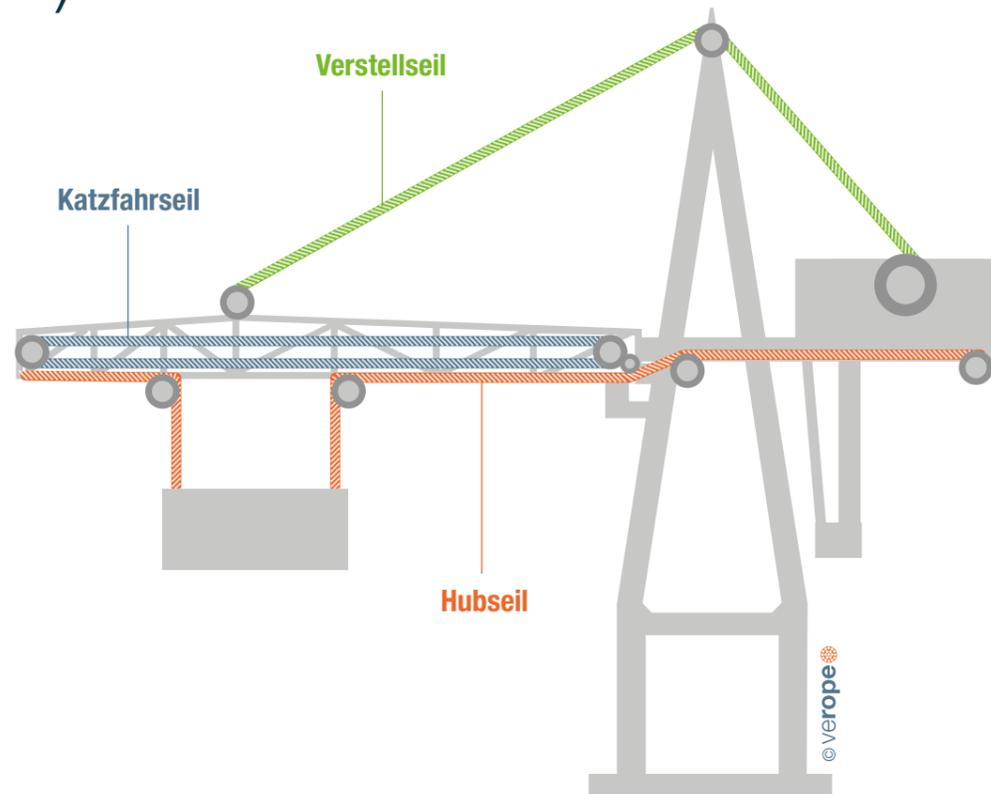
In der Regel werden bei dieser Anwendung die Hubseile paarweise, das heißt rechts- und linksgängig, eingesetzt.
