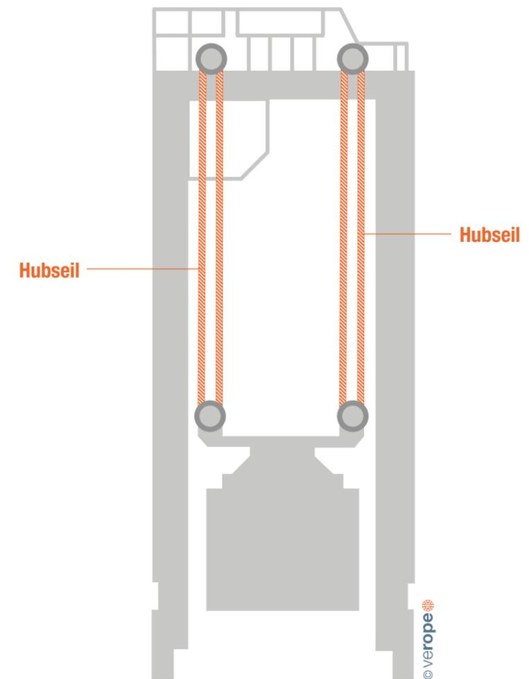
In der Regel werden bei dieser Anwendung die Spezialdrahtseile paarweise, das heißt rechts- und linksgängig, eingesetzt.
