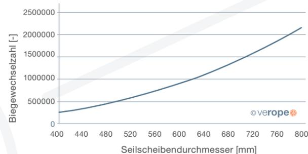
**Abb. 53:** Einfluss des Scheibendurchmessers auf die Seillebensdauer
