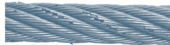
Abb. 40: Zustand bei 80% der Biegewechsel bis Bruch
