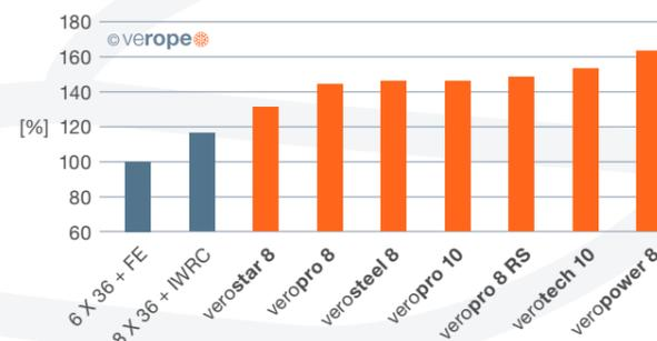
Abb. 30: Bruchkräfte nicht drehungsfreier Seile
