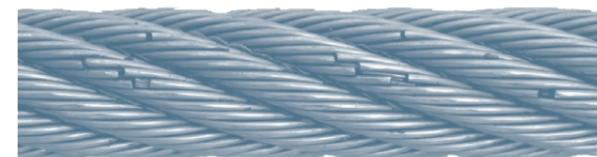
Abb. 39: Zustand bei 60% der Biegewechsel bis Bruch
