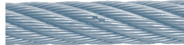
Abb. 38: Zustand bei 40% der Biegewechsel bis Bruch
