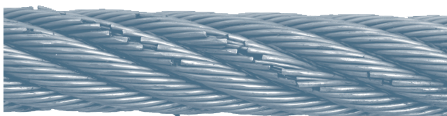
Figura 40: Estado al 80% del ciclo de flexión hasta el punto de rotura
