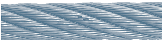
Figura 38: Estado al 40% del ciclo de flexión hasta el punto de rotura
