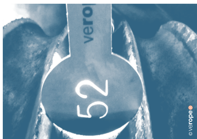
Figura 74: Calibre de la ranura (mostrado en una ranura demasiado estrecha)
