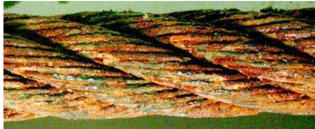
3. Oberfläche stark oxidiert. Einstufung: 60 % der Ablegereife.
