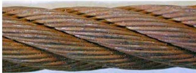
1. Beginnende Oxidation der Oberfläche, lässt sich abwischen, nur oberflächlich. Einstufung: 0 % der Ablegereife.
