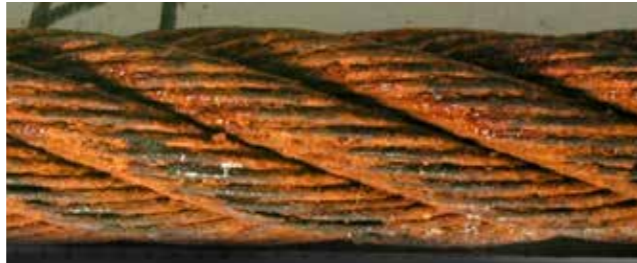
4. Oberfläche stark zerfressen, Drähte spannungslos, Lücken zwischen Drähten. Unverzügliche Ablage.
