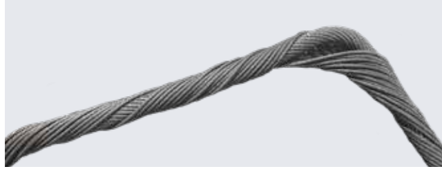
Heraustreten der Stahlseileinlage bei drehungsfreien Seilen
