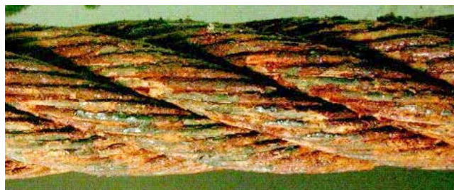
3. Superficie muy afectada por la oxidación - Clasificación: 60% hacia el descarte
