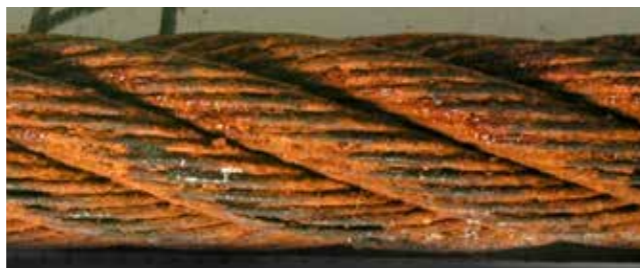
4. Superficie muy picada y cables bastante flojos, espacios entre cables - Deseche inmediatamente
