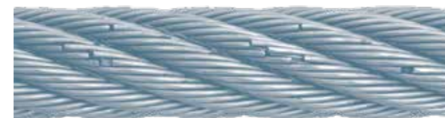
Abb. 39: Zustand bei 60% der Biegewechsel bis Bruch
