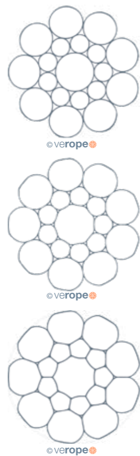
Abb. 8: Unverdichtete und verdichtete Rundlitzen
