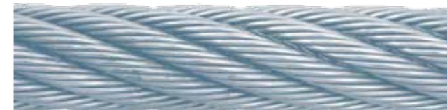
Abb. 37: Zustand bei 20% der Biegewechsel bis Bruch
