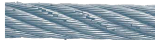
Abb. 40: Zustand bei 80% der Biegewechsel bis Bruch
