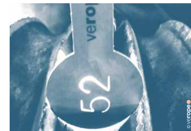
Abb. 74: Rillenlehre (hier in zu enger Seilrille)
