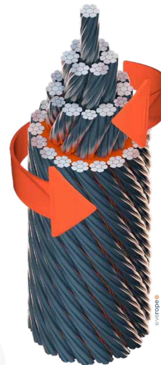
Abb. 21: Drehungsfreies Drahtseil verotop P – die Drehmomente von Herzseil und Außenlage wirken in entgegengesetzte Richtungen
