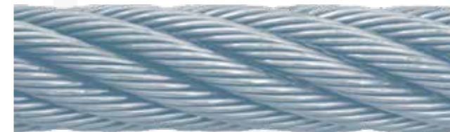
Abb. 36: Zustand bei 0% der Biegewechsel bis Bruch (Neuzustand)
