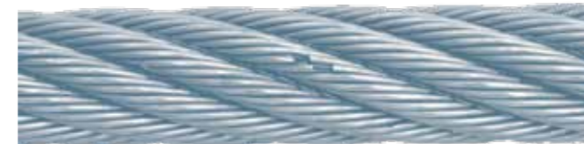
Abb. 38: Zustand bei 40% der Biegewechsel bis Bruch
