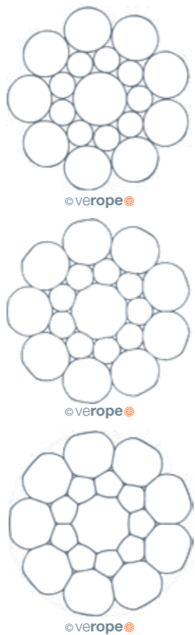
Figura 8: Cordones redondos sin compactar y compactados
