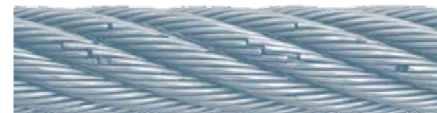
Figura 39: Estado al 60% del ciclo de flexión hasta el punto de rotura
