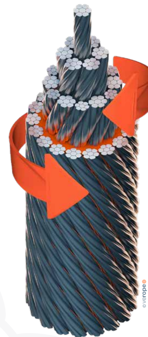
Figura 21: Cable resistente a la rotación verotop P: los pares de torsión del núcleo del cable y de la capa de torones exteriores, generados bajo carga, actúan en direcciones opuestas
