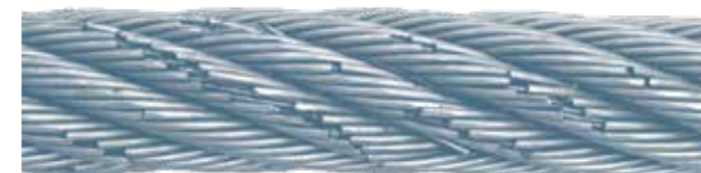
Figura 41: Estado al 100% del ciclo de flexión hasta el punto de rotura
