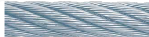
Figura 37: Estado al 20% del ciclo de flexión hasta el punto de rotura
